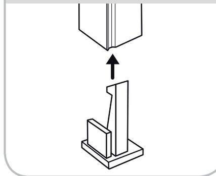
4. Insérer les coulisses dans les embouts de caisson (rainure coulisse côté intérieur).
