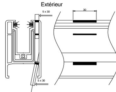
Traverse basse si largeur de vitrage inférieure à 1 m
