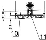
**10** DEPOT DE MASTIC ELASTOMERE SUR ENVIRON 13 MM D'EPaisseur AVANT CLIPAGE
