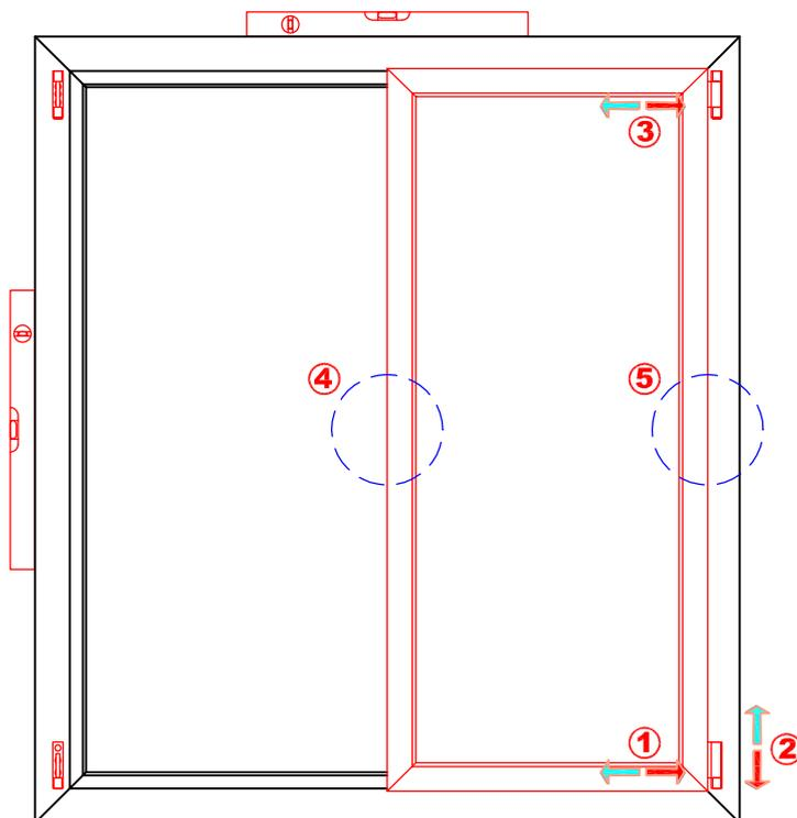
**1** Réglage latéral bas, à l'aide de la clé Allen n°4. (Vantail en position fermé).
