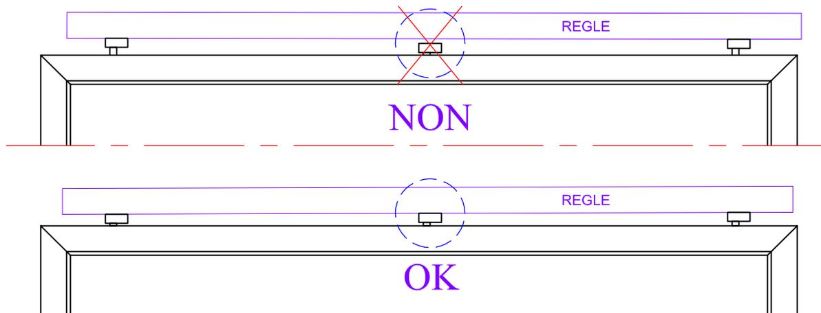
2 \* Réglage du vantail oscillo-battant (et ferrage symétrique)
