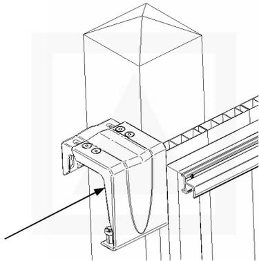
**NB : Positionner la platine parallèlement au sol**
