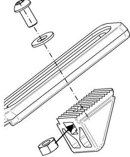
2 Monter le sous-ensemble dans la semelle en fonction de la position du dormant
