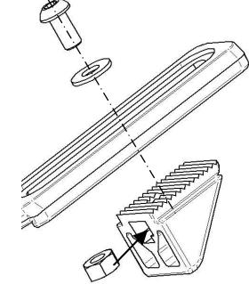
2 Monter le sous-ensemble dans la semelle en fonction de la position du dormant
